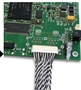
Abbildung 30: Abgesetzte Netzwerkschnittstelle Ethernet (AIFX-RE) an die Grundkarte CIFX 104-RE\F anschließen (Beispiel)
