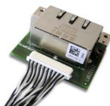
Abbildung 30: Abgesetzte Netzwerkschnittstelle Ethernet (AIFX-RE) an die Grundkarte CIFX 104-RE\F anschließen (Beispiel)
