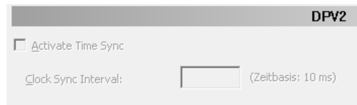
Abbildung 21: Konfiguration > DPV2 > Activate Time Sync, Clock Sync Interval – ausgegraut, da Time Sync vom Slave (GSD) nicht unterstützt
