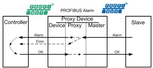
Figure 133: PROFINET IO- PROFIBUS-DP – Alarm Errors
