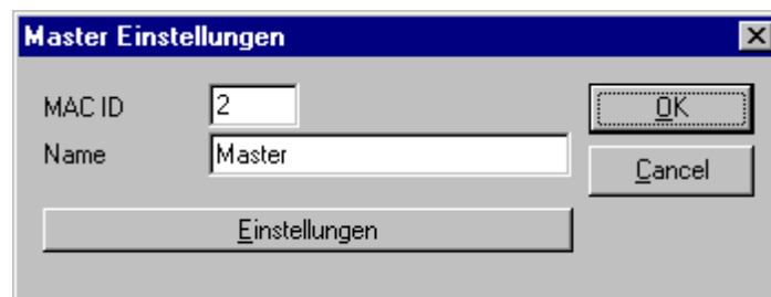
Abbildung 31: DeviceNet Master Einstellungen
