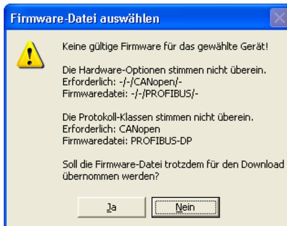
Abbildung 17: Abfrage Firmware-Datei auswählen – Beispiel Keine gültige Firmware
